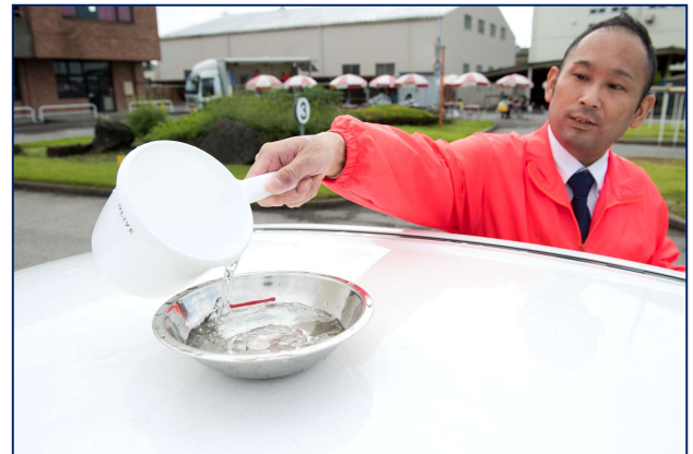
器いっぱいに入れた水を入れ、走行後に中側の赤い線まで残っていれば成功となる。
